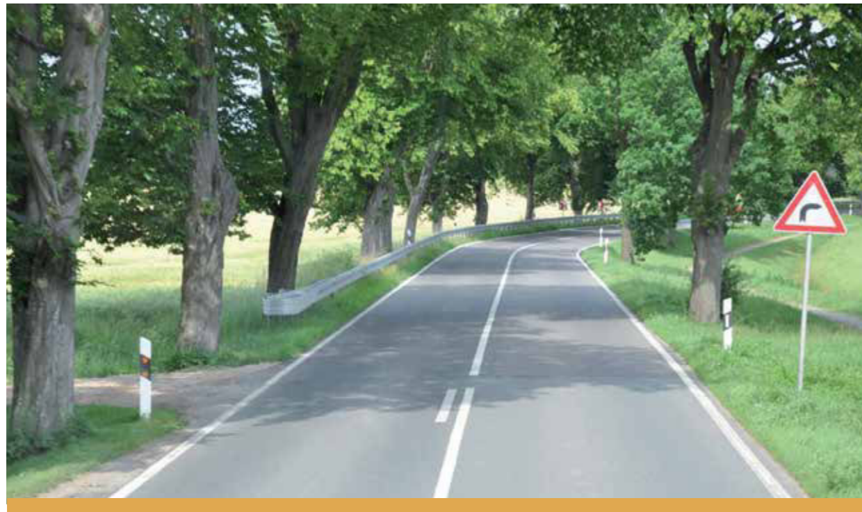
An gefährlichen Stellen dienen Schutzplanken gleichermaßen Mensch und Baum. Foto: TU Dresden
